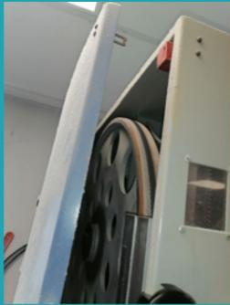
Les protecteurs mobiles, donnant accès aux volants d'entraînement supérieur et inférieur, sont équipés d'un asservissement du type verrouillage électrique à sécurité positive et difficilement fraudable
