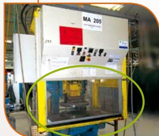
Le protecteur reste bloqué en position de fermeture jusqu'à ce que le risque d'accident ait disparu
