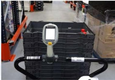
Socle sur timon permettant de reposer le terminal portatif
