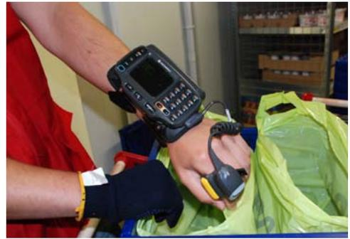
Fixation du terminal portatif à l'avant-bras et scan en doigtier
