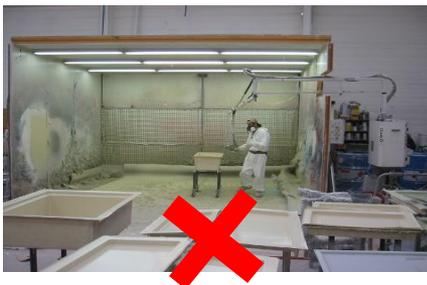
Ne pas stocker les pièces en cours de séchage dans la zone d'arrivée de l'air propre de la cabine.
