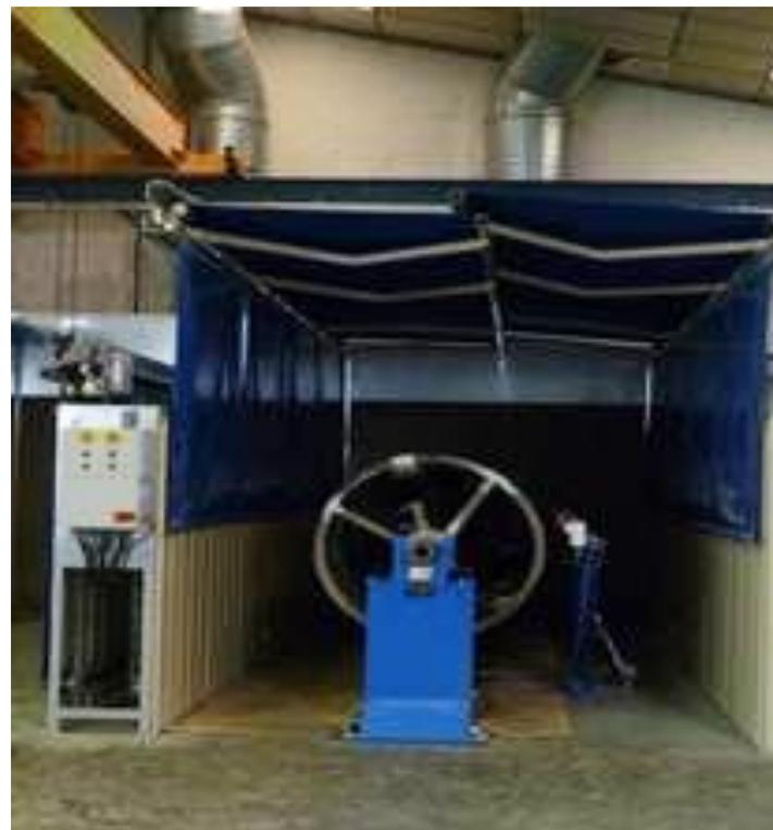
**Exemple** de polymérisation (séchage) d'une virole dans une zone dédiée et ventilée (aspiration vers le fond et augmentation de l'encoffrement par stores déroulés après manutention mécanique des pièces ).
