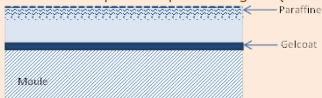
Ce type de résine est surtout intéressant pour les grosses pièces fabriquées par moulage au contact. On ne peut pas les utiliser pour les gelcoats sinon il y a des risques de délaminage des couches et un « blanchiment » .
