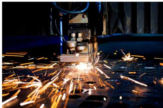
Le soufflage s'effectue avec de l'air ou des gaz de protection comme l'azote ou un mélange argon-hydrogène [3].
