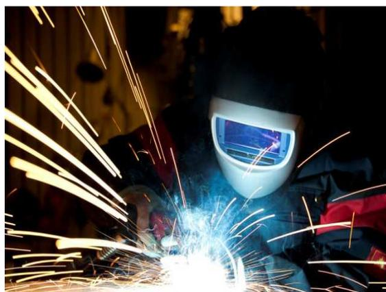
En pratique, l'opérateur gratte la surface à souder avec l'extrémité de l'électrode qu'il éloigne pour obtenir la longueur d'arc. L'écartement entre l'électrode et la pièce à souder est constant.
