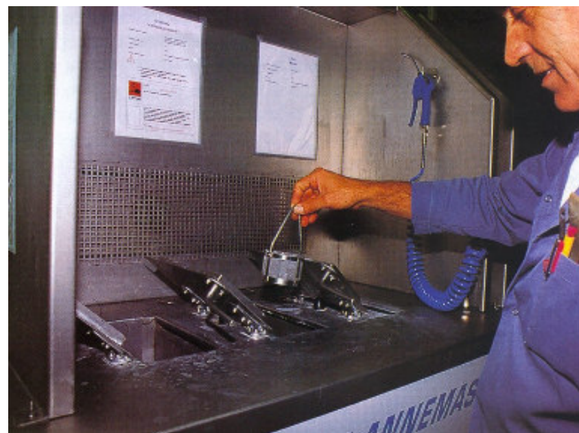
Cabine de dégraissage.
